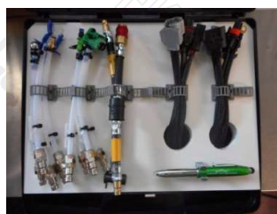
EQUIPAGGIAMENTO STANDARD (Include tutti i cavi iniettori e gli attacchi rifiuti di tutti i tipi gli iniettori)
