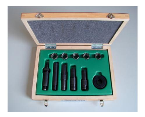
Cassetta composta da 6 pezzi per il montaggio e rismontaggio delle boccole del corpo pompa radial-jet; più 5 kit boccole a ricambio.
