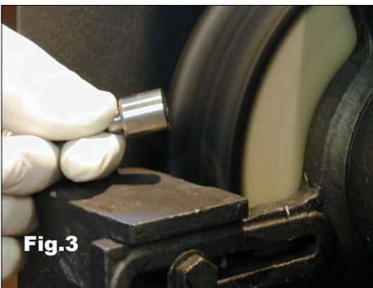
El cepillo cod.: **SICR** es indispensable para abrillantar el plano superior de retención de la tobera y del cuerpo inyector con tal de que no ocasionen perdidas; este metodo no deteriora y es mejor que el metodo manual utilizado sobre un cualquier plano (fig.3,4).
