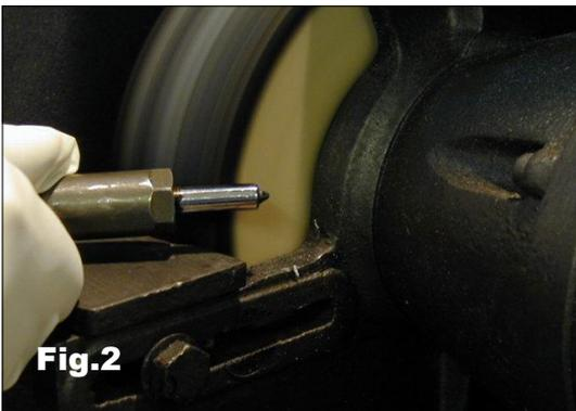
Se pueden limpiar e abrillantar las toberas de nueva generación (también Common-Rail) sin dañar la sección de los agujeros, para de este modo conseguir un resultado comparable con una pieza nueva (fig.2).
