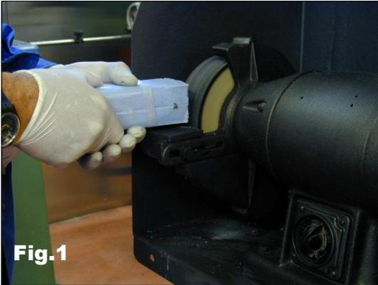
El cepillo para limpiar y abrillantar (cod. SICR) se aplica a una rueda de molino abriendo el agujero interior con la punta de una barrena según la dimensión del eje.
