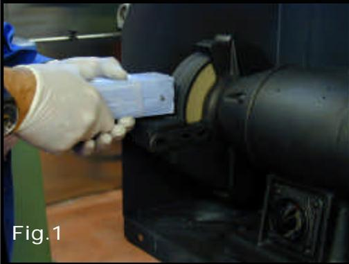
La spazzola per pulizia e lucidatura (cod. SICR) viene applicata ad una mola, allargando il foro interno con una punta di trapano in base alle dimensioni dell'albero.
