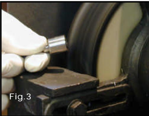
La spazzola cod.: SICR è indispensabile per lucidare il piano superiore di tenuta del pulverizzatore e del corpo iniettore, affinché non vi siano trafileamenti o perdite; questo metodo di lucidatura non altera la planarità, contrariamente a quanto avviene adoperando un qualsiasi piano di riscontro per la lucidatura manuale (fig.3,4).
