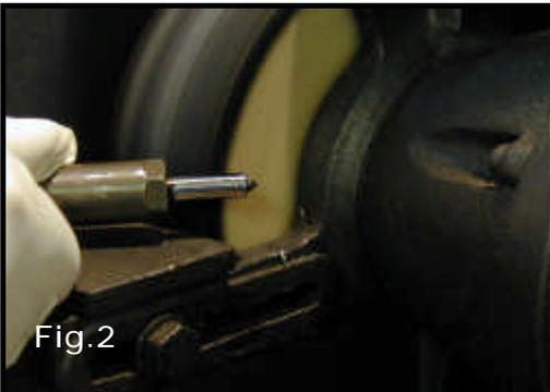
E' possibile pulire e lucidare i pulverizzatori di nuova generazione (anche Common-Rail) senza danneggiare la sezione dei fori, ottenendo un risultato paragonabile al nuovo (fig.2).
