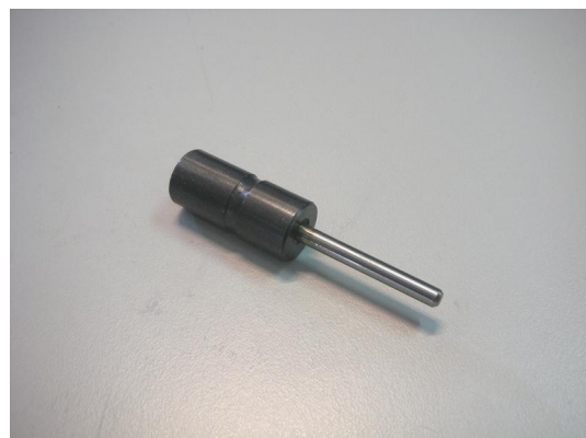
Estrattore boccola solenoide
