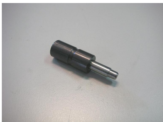
Introduttore boccola solenoide
