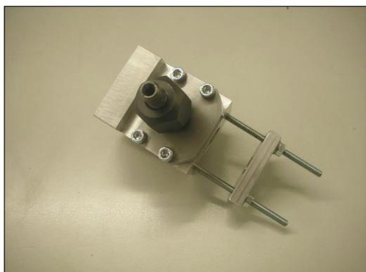
Blocchetto Iniettore Cummins - Scania XPI
