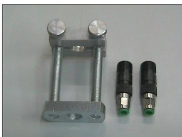
Kit morsetto per la rilevazione della portata degli iniettori Common-Rail, su banchi di prova con misurazione pressurizzata.
