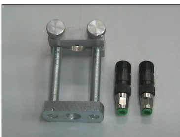
Kit grapas para medir el caudal de los inyectores Common-Rail, en bancos de prueba con medición presurizada.
