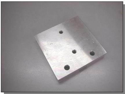
**SPESSORE PER CULLA PER BANCO DI PROVA HARTRIDGE**
