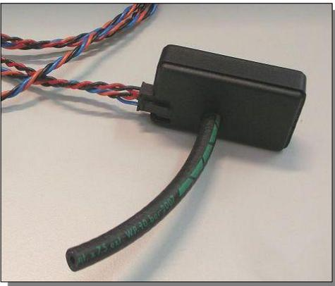
Decodificador con sensor 0-7 Bar
