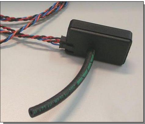
Decodificador con sensor 0-2 Bar
